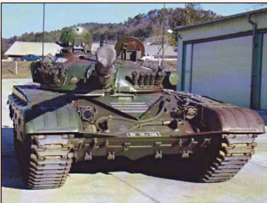
M-84A van het Sloveense leger. Met de installatie van een Tadiran TRC04 radio-installatie zijn ook twee antennes geplaatst, waardoor de tank zo nodig ook als commandotank kan worden ingezet.
