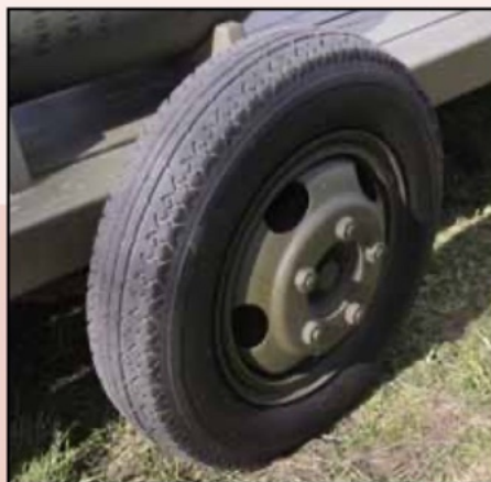
▲ De wielen van een bomtrailer met Highway profiel.
